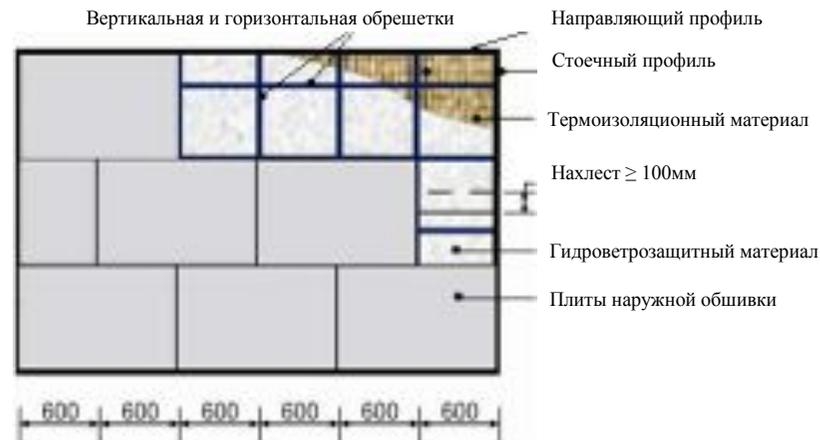
Рис. 12. Крепление наружной обшивки к каркасу
