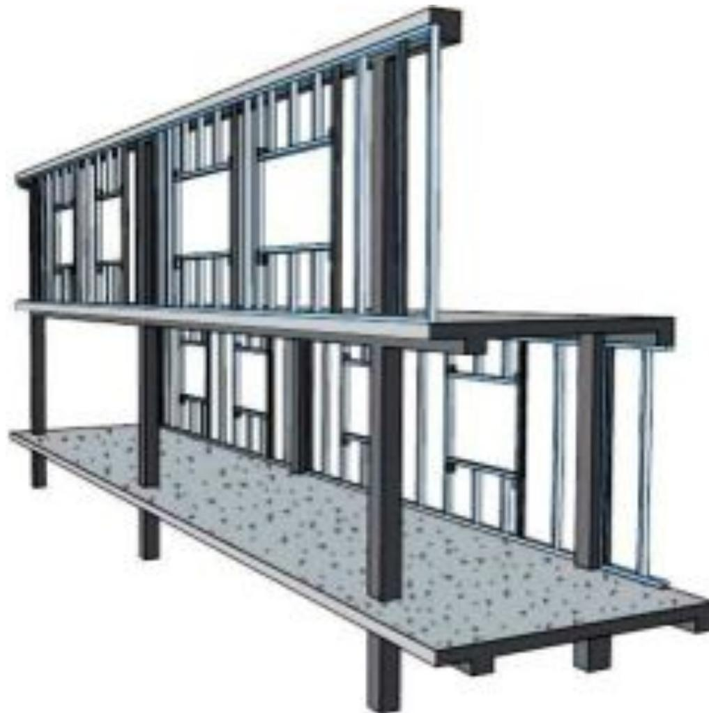
Рис. 1. Схематическое изображение типового здания со стальным каркасом
