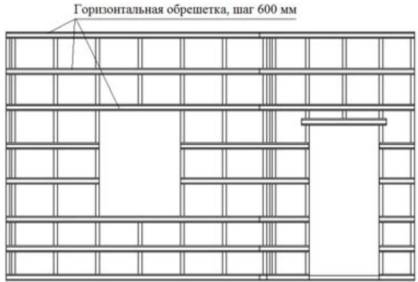
Рис. 4 Схема расположения горизонтальной обрешетки
