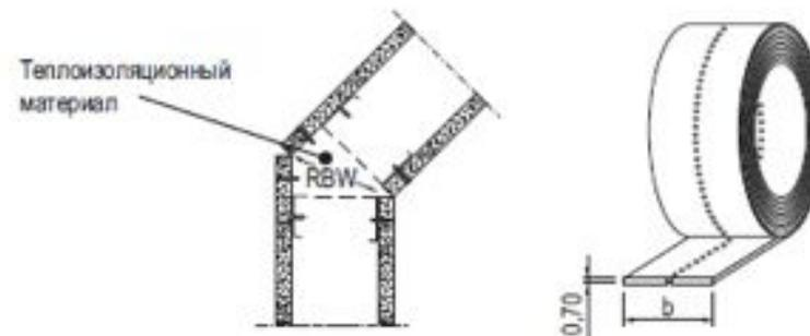
Рис 6. Соединение стеновых панелей под произвольным углом
