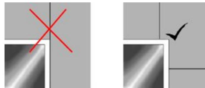
Рис. 13. Крепление плит в области проема
