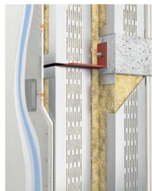
Двухконтурная конструкция стены
